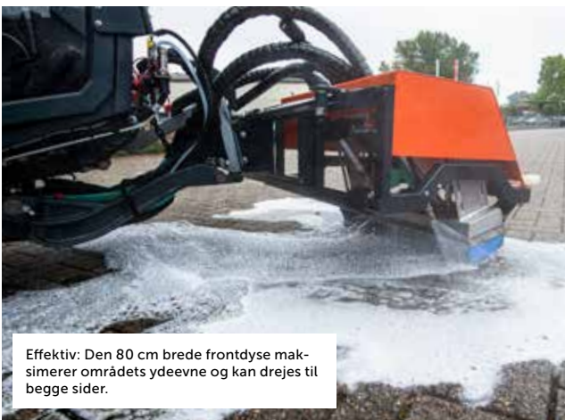
Intuitiv: ELMOTherm®-processen og frontdysen kan fjernstyres fra kabinen.
